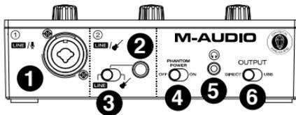
4. **ファンタム電源 (+48V) スイッチ**：このスイッチで、ファンタム電源の ON/OFF を切り替えます。ON の際はトップパネルのファンタム電源 LED が点灯し、ファンタム電源が**コンボ入力端子**に供給されます。ダイナミックマイクやリボンマイクなどにはファンタム電源を必要としないものが一般的ですが、一般的なコンデンサマイクはファンタム電源を必要とします。ファンタム電源の必需性に関しては、ご使用になるマイクの説明書をご参照ください。
